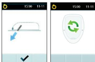
✓ drücken, damit die weiche Kanüle in die Haut eingeführt wird. Der Pod wird nun automatisch die erste Dosis injizieren.
